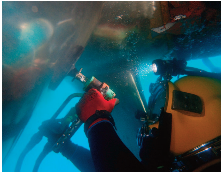
Buzo industrial realizando un pulido de una hélice de un buque. - Trident Underwater Services (Wärtsilä Group)
