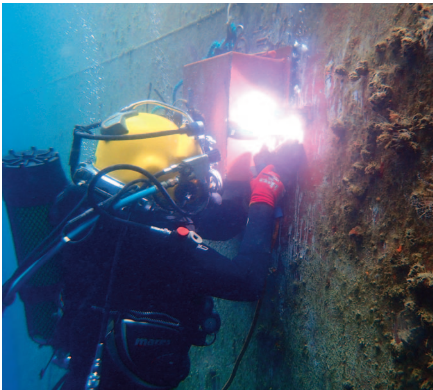
Imagen de un buzo comercial realizando trabajos de reparación al casco de un buque. Trident U.S.
