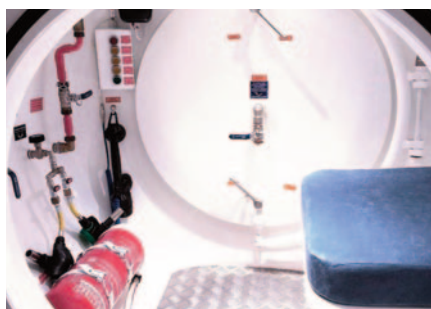
Detalles de la antecámara y entrada de las cámaras hiperbáricas multiplaza fabricadas por IBERCO. IBERCO
