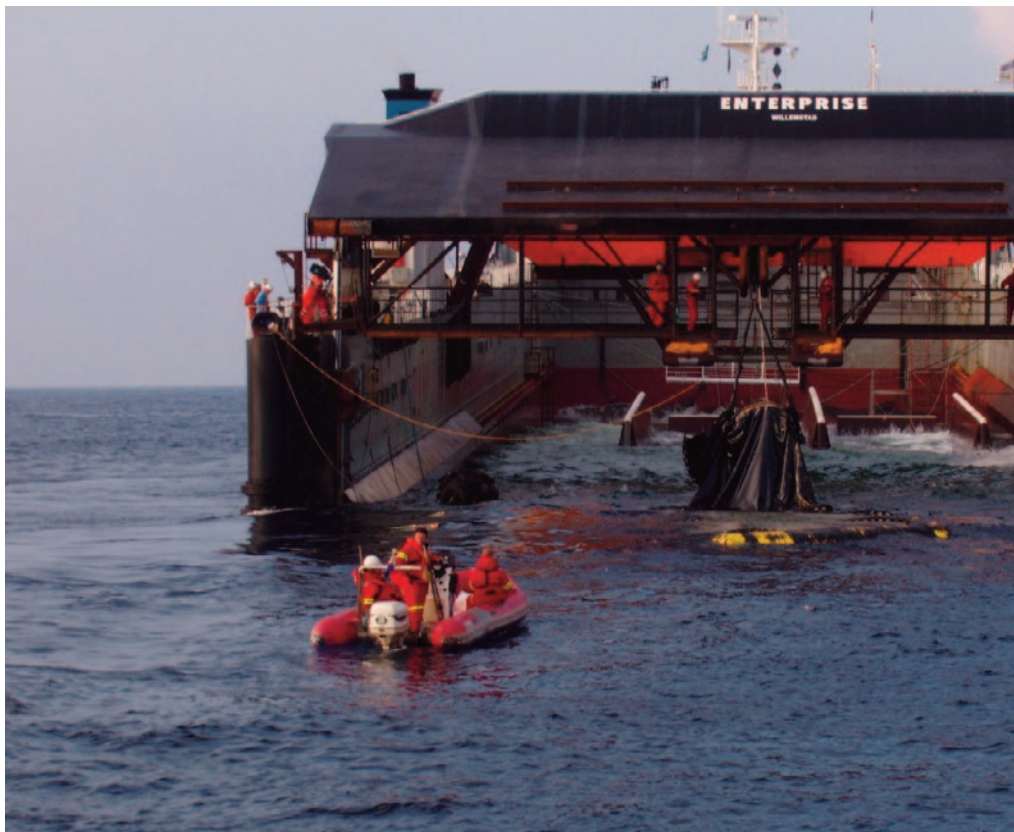
El Enterprise, dique flotante que recogía el fuel de las bolsas de plástico usadas en la primera prueba. Foto: Luis Torcidas
