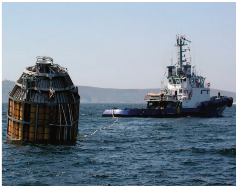
Una de las lanzaderas de aluminio extruido en posición vertical, antes de ser sumergida. Foto: Luis Torcida
